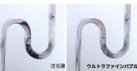
【実験方法】排水管に疑似汚れを溜め、流水7L/分で通水。
